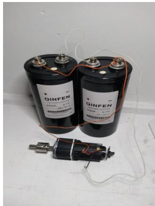
Fig. 13. Carga con motoreductor del circuito de rectificación y carga de la antena monopolo m con sistema de operación autónoma.
